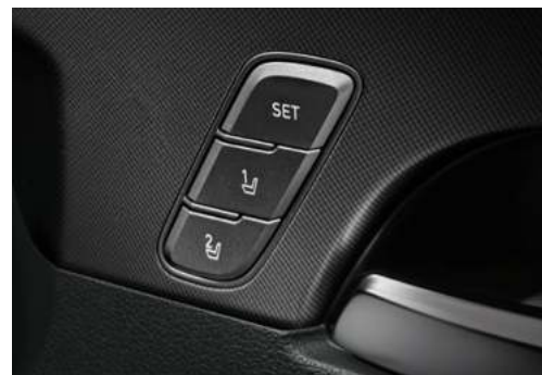
Integrated Memory System (IMS) ตำแหน่งที่นั่งคนขับ สามารถบันทึกการตั้งค่าได้ 2 รูปแบบ ตามสรีระและความเหมาะสมของผู้ขับขี่
