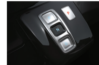
Electronic Gear Shift Button ระบบเปลี่ยนเกียร์แบบปุ่มกด Shift-by-wire
