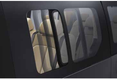
Flush Glass กระจกแบบ Flush Glass บนประตูสไลด์ทั้งสองข้าง สามารถเปิดรับลมได้โดยไม่ต้องเปิดประตูสไลด์
