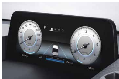
10.25" Full LCD Cluster ข้อมูลการขับขี่แสดงบนจอ LCD ความละเอียดสูง แบบดิจิทัลล้ำสมัย ติดตั้งในระดับสายตาผู้ขับขี่ ปรับเปลี่ยนสไตล์ได้ตามโหมดที่เลือก
