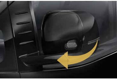
Electronic Adjust & Folding Side Mirror กระจกมองข้างปรับและพับเก็บด้วยระบบไฟฟ้า
