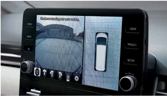
Surround View Monitor (SVM) จับจ้องมันใจด้วยระบบกล้องรอบทิศทางอัจฉริยะ- แสดงภาพรอบตัวรถ หลากหลายมุมมอง ช่วยลดอุปสรรคจากทุกจุดอับสายตา
