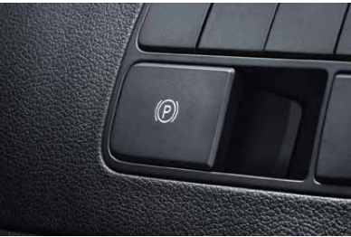
Electronic Parking Brake (EPB) with Auto Hold เบรกมือไฟฟ้าพร้อมระบบ Auto Hold ใช้งานได้ง่าย และสะดวกสบายยิ่งขึ้น
