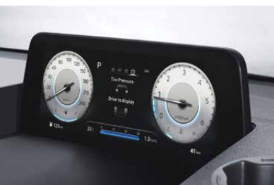
Tire-pressure Monitoring System (TPMS) ระบบแสดงค่าแรงดันลมยางและแจ้งเตือนอัตโนมัติ บนหน้าจอ Full LCD Cluster
