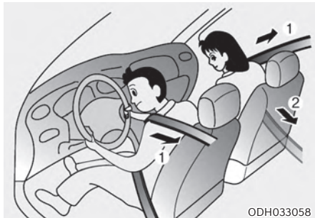
[1] : ระบบดึงกลับเข็มขัดนิรภัยแบบ Pre-tensioner เบาะหน้าและเบาะหลังด้านนอก
