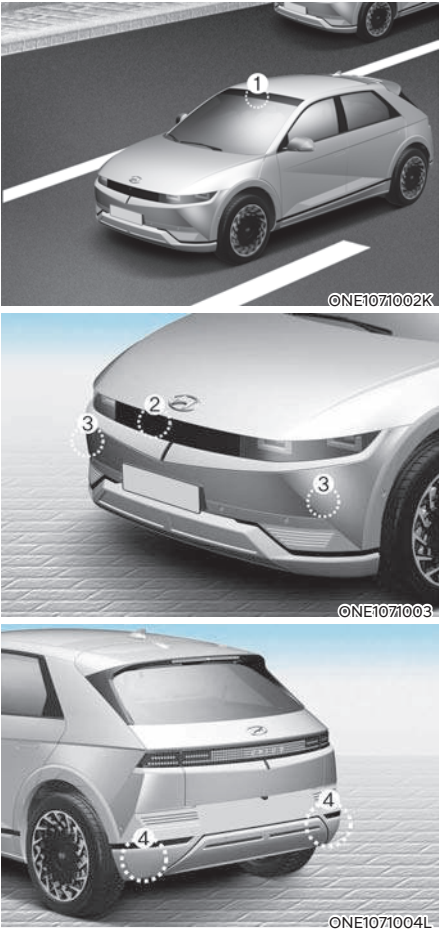
[1]: กล้องตรวจจับด้านหน้า, [2]: เรดาร์ด้านหน้า [3]: เรดาร์ที่มุมด้านหน้า (ถ้าติดตั้ง) [4]: เรดาร์ที่มุมด้านหลัง (ถ้าติดตั้ง)
