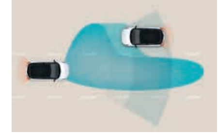
Uzun Far Asistanı (HBA) Minimum stres, maksimum görüş. Uzun Far Asistanı, karşıdan gelen araçların yanı sıra aynı şeritte giden öndeki araçları da algılayarak, gerektiğinde uzun fardan kısa fara geçiş yapar.
