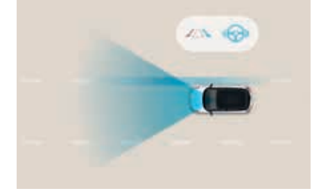
Şeritte Kalma Asistanı (LKA) Bu sistem, yol şeritlerini takip etmek için ön kamerayı kullanır. Şeritten istenmeden çıkılması durumunda sürücüyü uyarır ve aracı doğru şeride geri yönlendirmek için direksiyona karşı tork kuvveti uygular.
