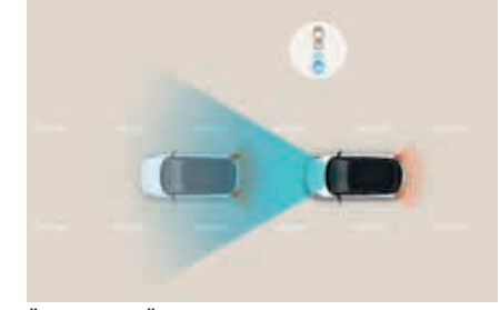
Ön Çarpışma Önleme Asistanı (FCA) Önündeki yolu bir radar ve kamera yardımıyla algılayan FCA sistemi, öndeki araç ani fren yaptığında ya da yolda yaya veya bisiklet olması durumunda otomatik olarak fren yapar.
