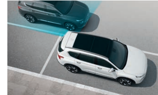
Güvenli Çıkış Asistanı (SEA) Bu akıllı özellik, arkadan yaklaşan araçları algılayarak ve arka kapılardaki çocuk kilidini geçici olarak devreye alarak, yolcuların yalnızca güvenli olduğunda araçtan çıkmasına izin verir. Bu sayede kazaların önlenmesine yardımcı olur.
