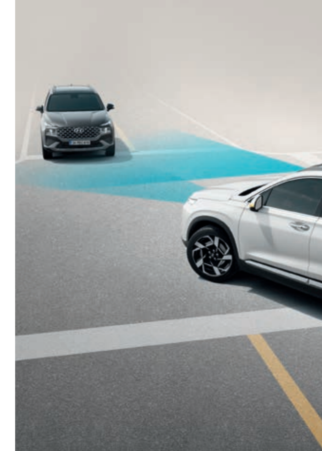
Ön Çarpışma Engelleme Asistanı (FCA-JX, kavşak dönüşü desteği) FCA sistemi, öndeki araç ani fren yaptığında ya da yolda yaya veya bisiklet olması durumunda sizi uyarır ve otomatik olarak fren yapar. Sistem, kavşaklarda sola dönüş sırasında üzerinize gelen araçların yarattığı çarpışma riskleri için de devreye girer.
