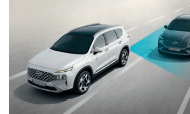
Kör Nokta Çarpışma Önleme Sistemi (BCA) Alt arka tamponda yer alan radar sensörlerini ve ön taraftaki kamerayı kullanan sistem, kör noktada kalan araçlar konusunda sizi uyarır. Böyle bir durumda sinyal lambasını çalıştırırsanız, araç çarpışmayı önlemek için sesli bir uyarı verir ve fren yapar.
