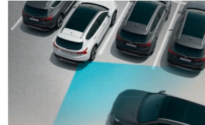
Arka Çapraz Trafik Çarpışma Önleme Asistanı (RCCA) Görüşün kısıtlı olduğu dar alanlardan geriye doğru çıkarken yandan yaklaşan bir araç olması hâlinde sürücüyü uyarır ve gerekli durumlarda otomatik olarak fren yapar.
