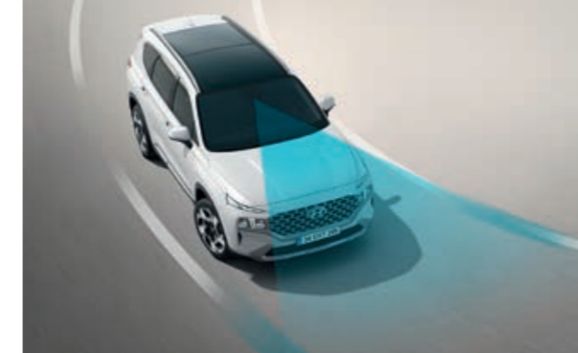
Şerit Takip Asistanı (LFA) LFA özelliği etkinleştirildiğinde, otoyollarda ve şehir içinde 0 ila 180 km/sa hızla giderken, aracı ortalayarak kendi şeridinde tutar.
