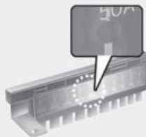
В перегоревшем состоянии
