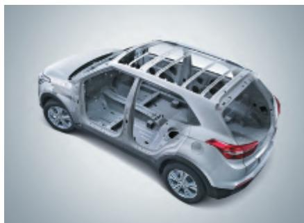
Усиленный жёсткий каркас выполнен из особого сплава высокопрочных сталей AHSS, превосходящего сплавы, применяемые в автомобилестроении.
