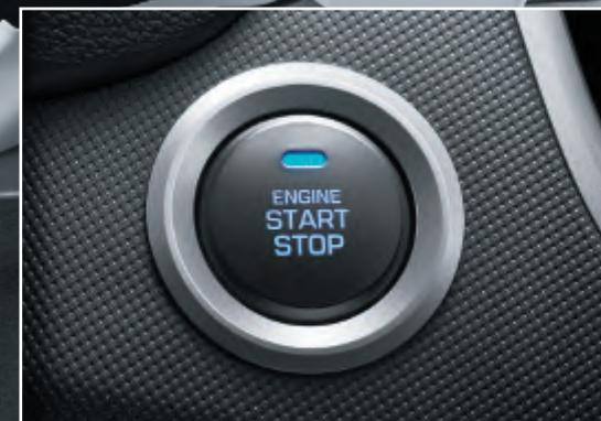
Включение двигателя осуществляется простым нажатием на КНОПКУ ЗАПУСКА (при нахождении SMART KEY в салоне автомобиля)
