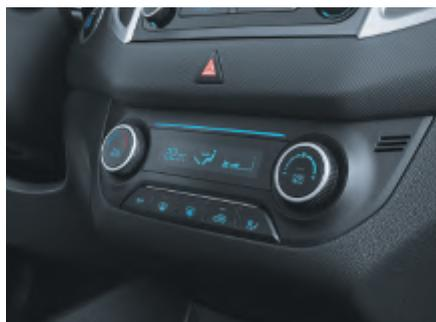
Просто установите комфортную температуру один раз – и система климат-контроля будет постоянно поддерживать её.
