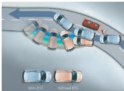
Система курсовой устойчивости (ESC) улучшает сцепление с дорогой при резких поворотах и торможении.
