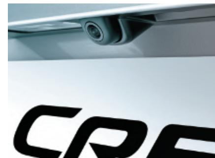
Встроенная камера заднего вида показывает траекторию движения автомобиля при движении назад и делает парковку удобной и безопасной.
