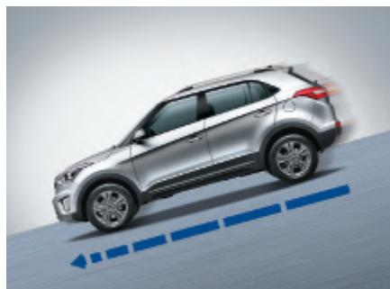
Помощь при спуске с горы (DBC) регулирует тормозное усилие и исключает проскальзывание колёс на спуске.
