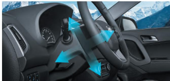
Регулировка рулевого колеса по высоте и вылету поможет создать комфортные условия управления автомобилем.
