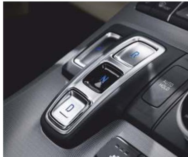
Переключение режимов 8-ступенчатой автоматической коробки передач кнопками
