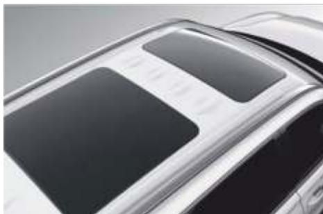
Двухсекционная панорамная крыша
