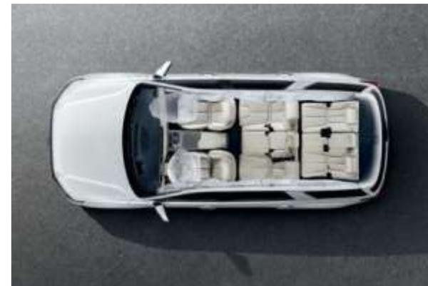
7 подушек безопасности (фронтальные подушки для защиты водителя и переднего пассажира, передние боковые подушки безопасности, подушки безопасности для коленей водителя и шторки безопасности для защиты при опрокидывании)
