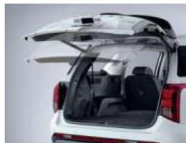
Система электропривода двери багажника автомобиля
