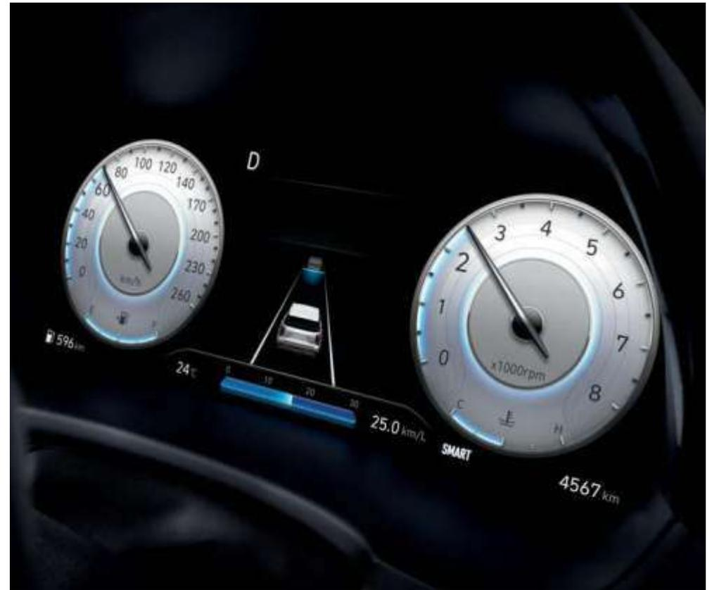
Цифровая панель приборов Supervision диагональю 12,3 дюйма
