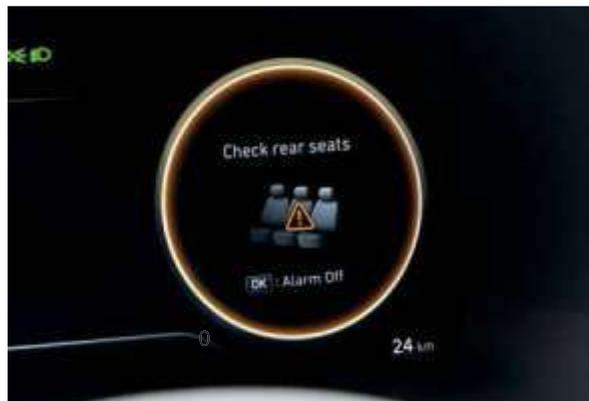
Функция предупреждения о присутствии пассажиров на задних сиденьях (ROA); система экстренного торможения для предотвращения вторичных столкновений (МСВ)
