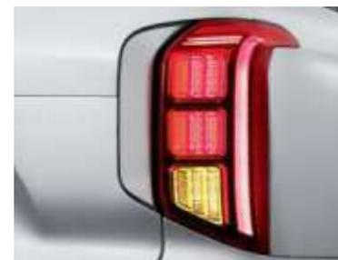
Светодиодная задняя оптика
