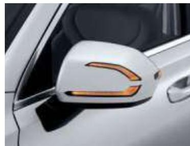
Светодиодные повторители указателей поворота на корпусах наружных зеркал заднего вида
