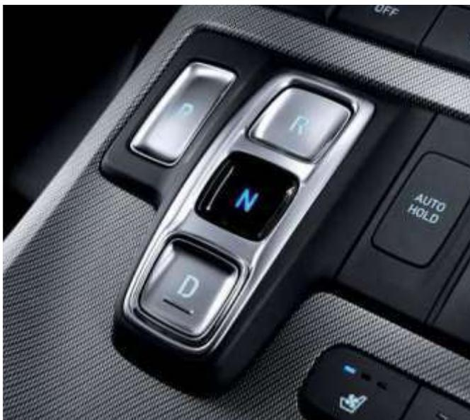
8-ступенчатая автоматическая коробка передач с кнопочным управлением
