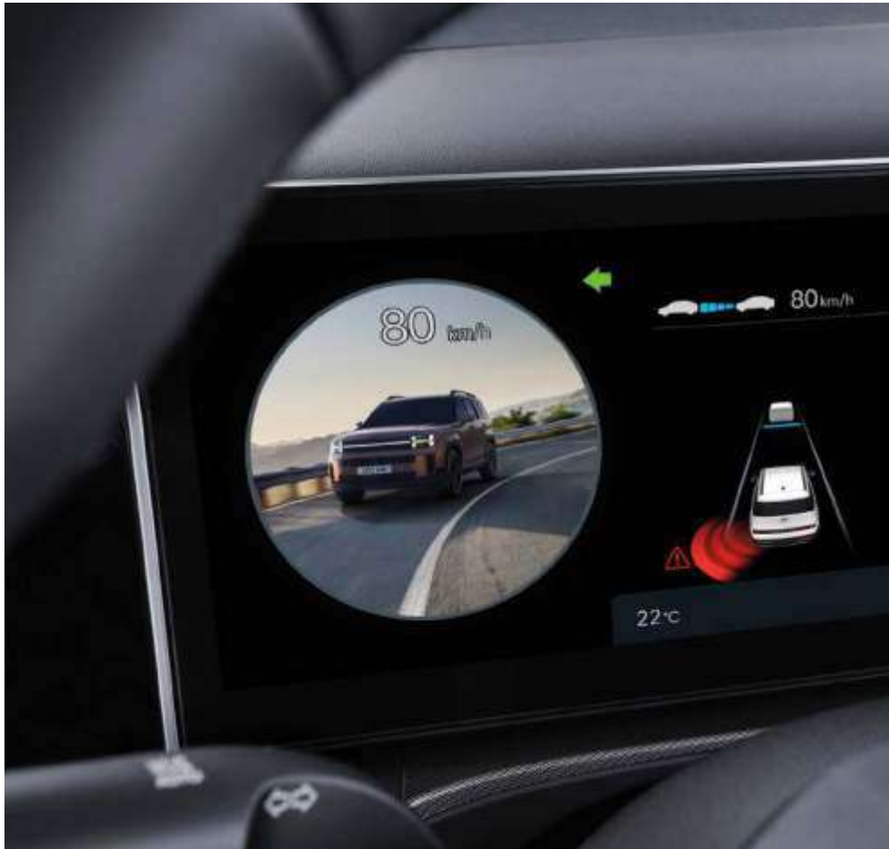
Система мониторинга слепых зон (BSM)
