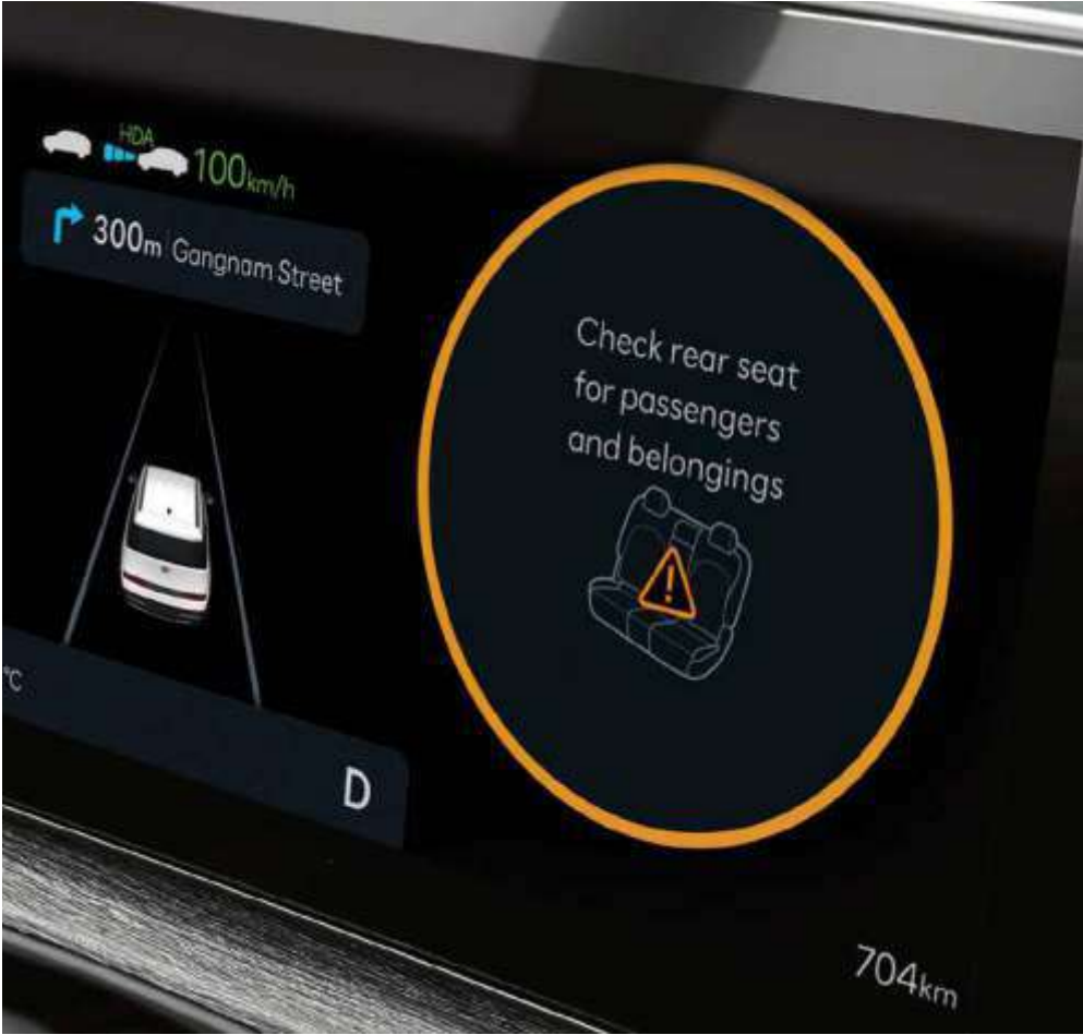
Усовершенствованная система оповещения о присутствии пассажира на заднем сиденье (ROA)
