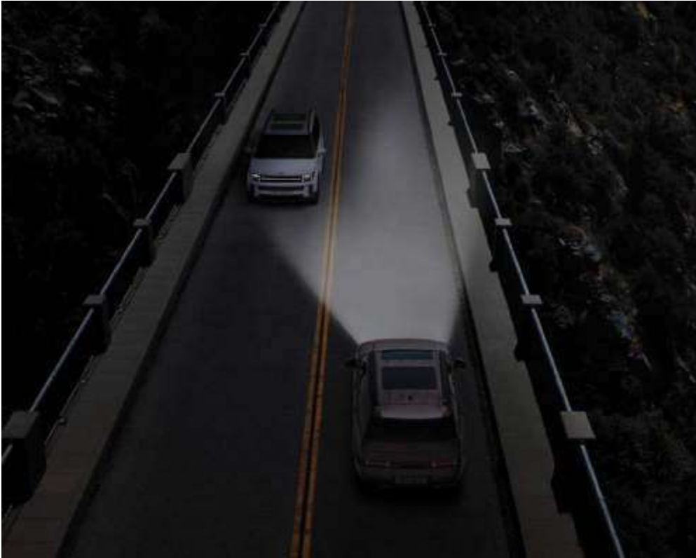
Система автоматического управления дальним светом (НВА) Распознает окружающий свет, в частности лучи фар встречного или впереди идущего автомобиля, и автоматически переключает дальний свет на ближний.
