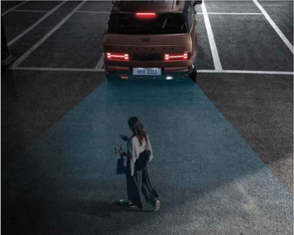
Система предотвращения столкновения при движении задним ходом (РСА) Предупреждает, если при движении задним ходом возникает риск столкновения с каким-либо объектом. Если после предупреждения риск столкновения сохраняется или возрастает, система автоматически применяет экстренное торможение.
