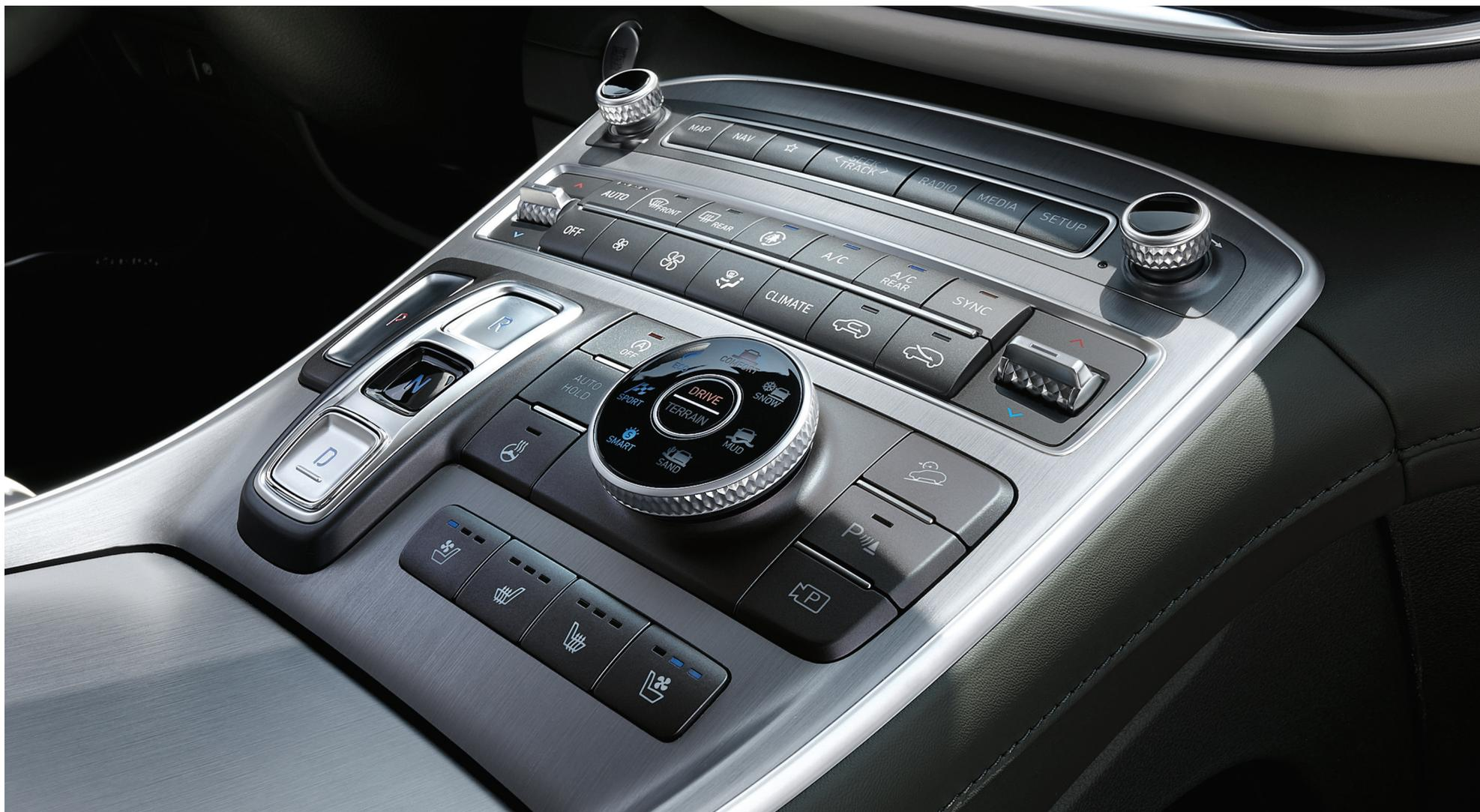
Центральная консоль «Парящего» типа и автоматическая коробка передач «Shift-by-wire».
