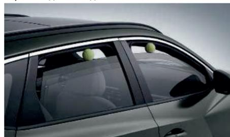
Электрические стеклоподъемники с функцией защиты от защемления
