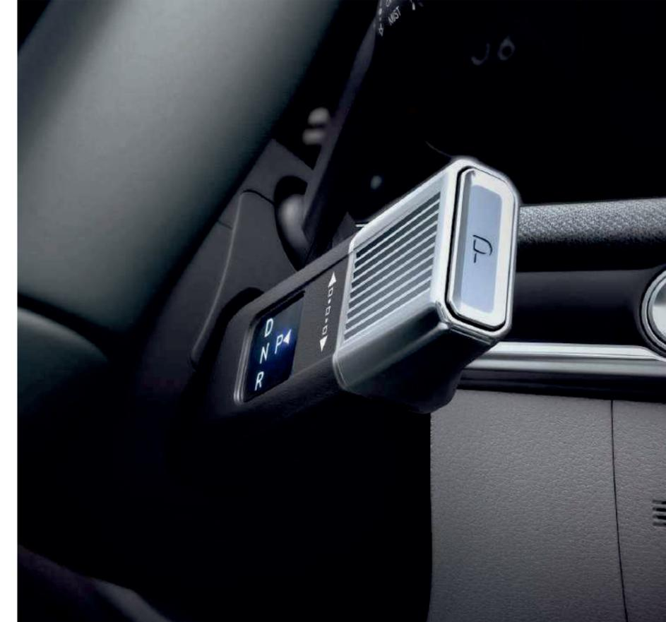
Рычаг селектора передач на рулевой колонке (SBW)
