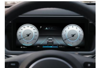
Полностью цифровая приборная панель диагональю 10,25 дюймов
