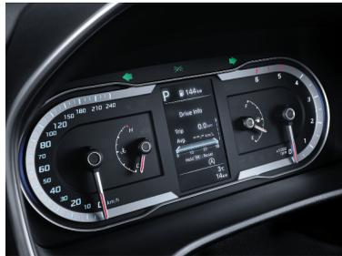
Панель приборов Supervision с 4,2-дюймовым TFT-экраном
