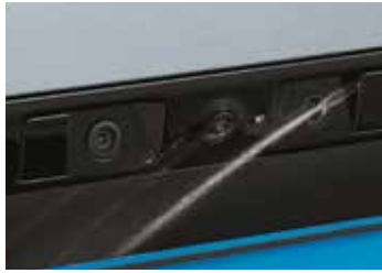
3중 카메라 클리닝 시스템 : 후방 모니터, 디지털 센터 미러, 빌트인 캠 2
