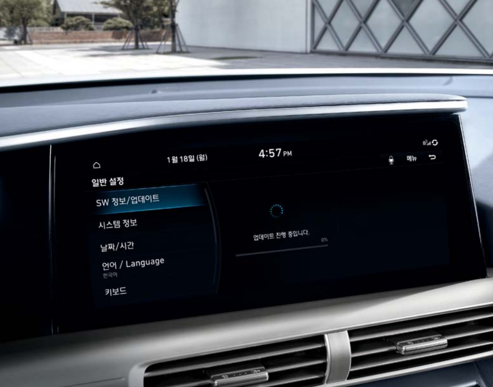
무선 인포테인먼트 업데이트 지도와 인포테인먼트 시스템을 최신 버전으로 업데이트 할 수 있습니다. * 블루링크 가입 후 이용할 수 있습니다. * 인포테인먼트 시스템 화면 이미지는 업데이트에 따라 변동될 수 있습니다.
