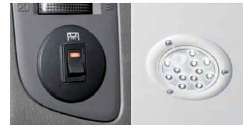
화물실 인체감지 센서 실내등 및 스위치 실내등 스위치를 켜면 센서가 작동되어 작업자가 화물실에 가까이 가면 등이 켜지고 멀어지면 꺼지는 자동 센서 실내등이 적용되었습니다.
