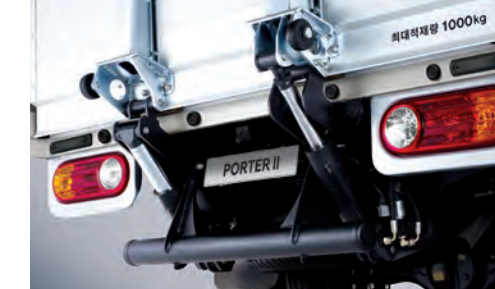
파워게이트 턴인타입 리프트 시스템 (허용하중 : 600kg, 플레이트 중심기준)
