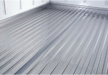
요철형 스테인리스 바닥 (냉동탑차) -SUS304
