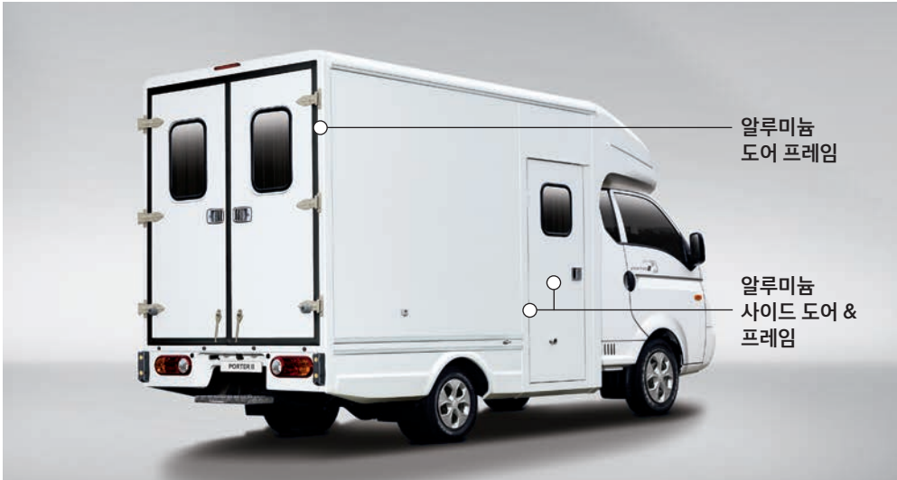
알루미늄재질 프레임 적용으로 방청 성능 향상 (적용 부위 : 사이드 도어 & 프레임, 리어 도어 프레임)
