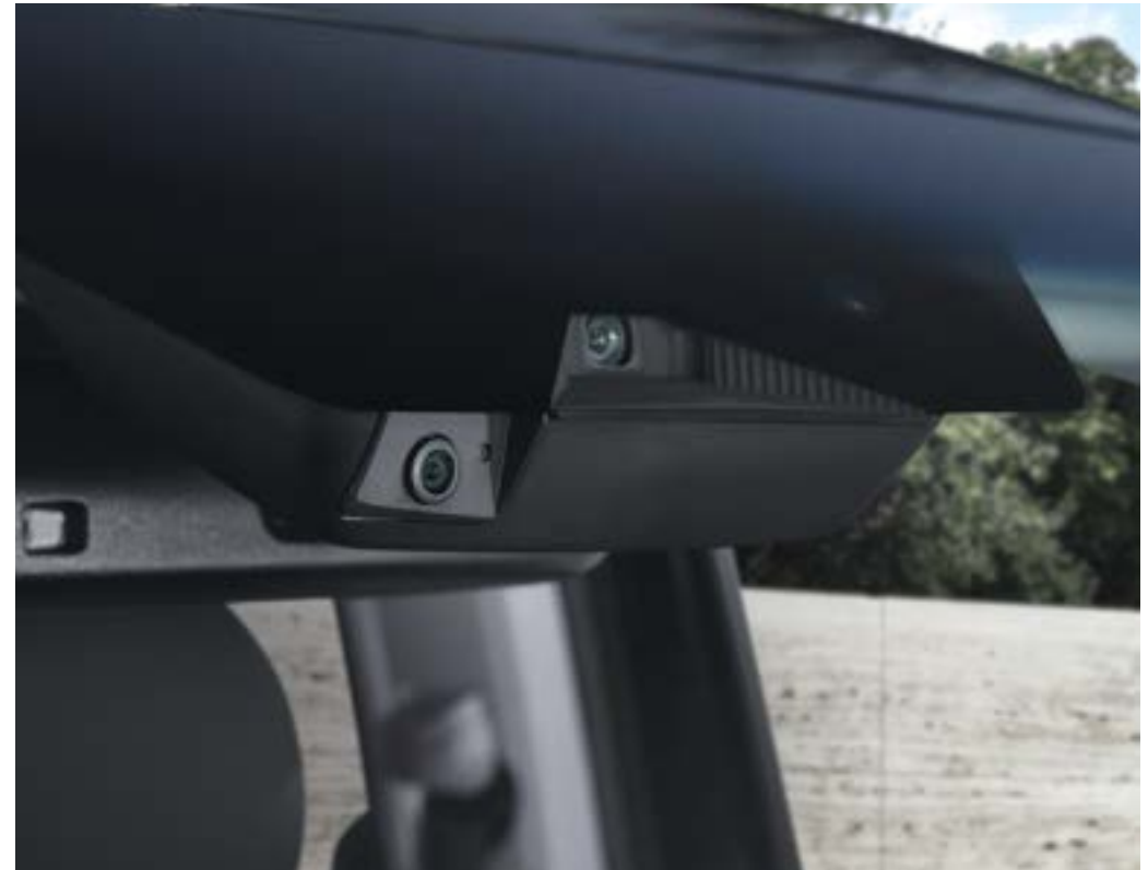
빌트인 캠 차량의 전/후방에 고화질 카메라가 내장된 영상기록 장치로 상시, 주차 중, 이벤트, 타임랩스 등 영상을 손쉽게 저장할 수 있습니다.
