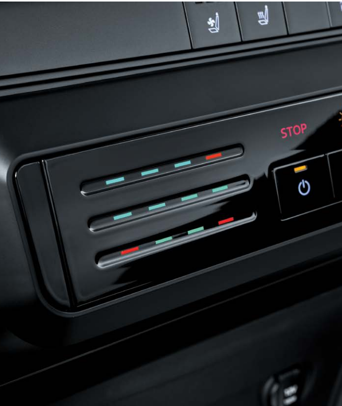
안전벨트 착용 및 착좌 확인 시스템(15인승) 안전벨트 착용 및 어린이의 착석 상태를 확인하여 벨트 미착용/오착용과 급출발로 인한 부상 등의 사고를 방지합니다. 1) 표시 꺼짐 : 시트 미착석 및 벨트 미착용 시 꺼짐 2) 적색 표시 : 시트 착석 후 벨트 미착용 시 점등 3) 녹색 표시 : 벨트 착용 시 점등(시트 착석과 무관)
