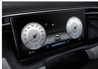
Full LED 헤드램프 (MFR 타입, 히든라이팅 주간주행등 포함) 클러스터 (10.25인치 컬러 LCD, 오픈형)
