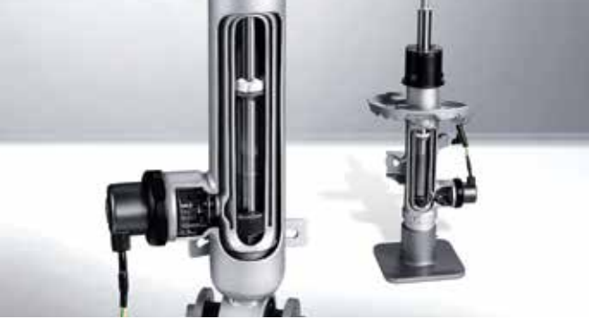
전자 제어 서스펜션 (ECS, Electronic Control Suspension) 운전상황에 맞게 각 휠의 속업소버 감쇠력을 제어하여 트랙과 일상, 모든 주행 조건에서 차별화된 성능을 구현합니다.
