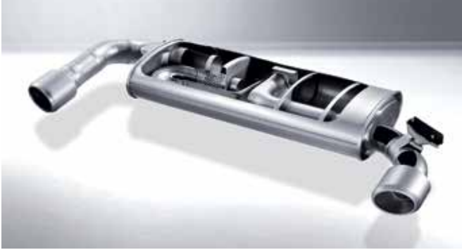
능동 가변 배기 시스템 (Variable Exhaust Valve) 배기 파이프의 형상과 전자식 가변 밸브를 이용하여 운전상황에 맞게 정숙하거나 스포티한 배기음을 선사합니다.
