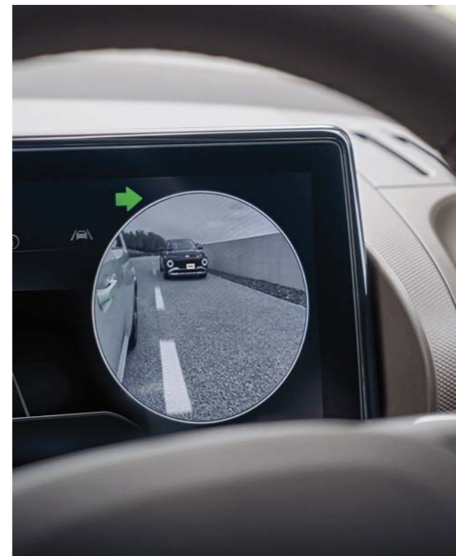
ブラインドスポットビューモニター (BVM) 車線変更時にウィンカー操作と連動して、メータークラスター内にドアミラーよりも広い視野で映像を表示し、安全な運転をサポートします。
