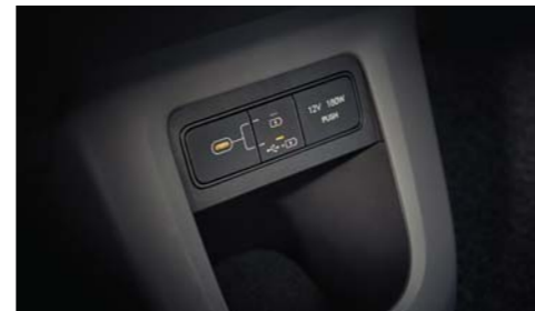
USBポート/Type-C (前席に充電&通信×1、スライディングコンソールに充電×2、 後席に充電×2)
