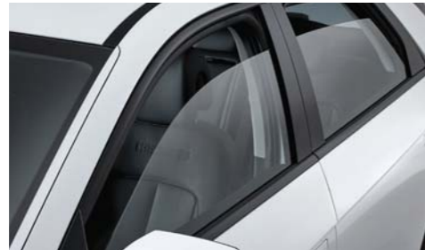
遮音機能付合わせガラス (ウインドシールドガラス、1列目&2列目ドアガラス)
