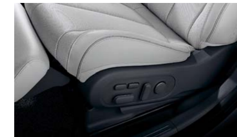
助手席パワーシート [8Way+2Wayランバーサポート+2Wayレッグレスト]
