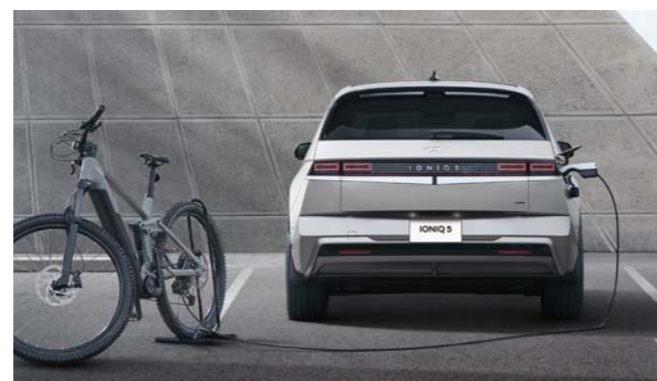
室内V2L(Vehicle to Load) 【最大出力1,600W(室外V2Lとの合計)】 リヤシート下部に室内V2L(AC 100Vコンセント)を装備。 室内で電気製品の使用が可能です。 室外V2L(Vehicle to Load) 【最大出力1,600W(室内V2Lとの合計)、コネクター付】 標準装備のコネクターを使い、室外でAC 100Vの電気製品を使用できます。 室外V2L機能は、外出先の様々な状況でご自宅のように電気製品を使えます。 ※ V2Lは室内+室外の合計で、最大1,600Wまで使用可能です。
