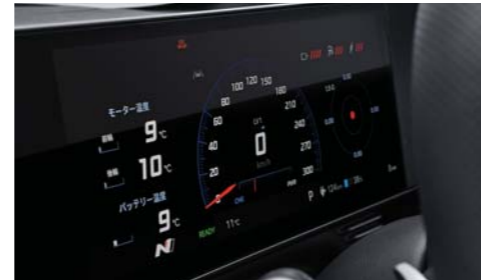
12.3インチフルサイズカラーLCDクラスター (N専用グラフィック仕様)
