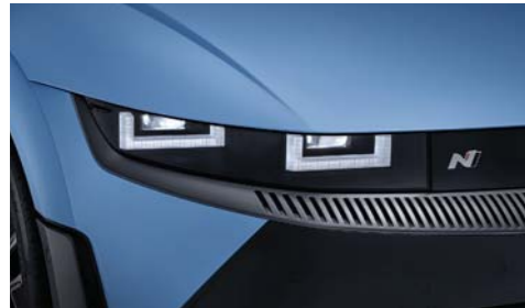
フルLEDヘッドランプ (プロジェクションタイプ)、LED DRL&ターンランプ
