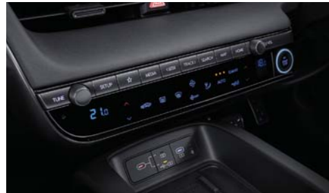
左右独立温度コントロールフルオートエアコン (アフターブロー機能、マイクロエアフィルター、オートデフォグガー、PM センサー、空気清浄モード付)
