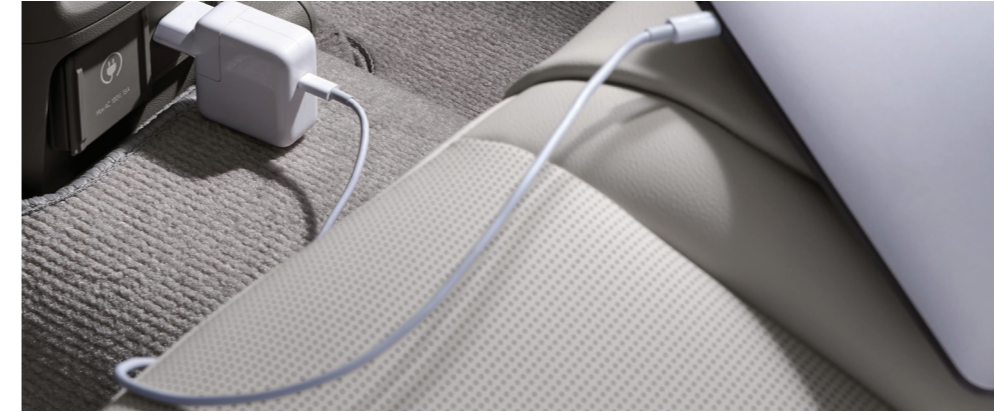
室内V2L (Vehicle to Load) [100 V/最大出力 1,500W] センターコンソール後端にコンセントを設置し、車内で家電などへの電力供給が可能です。
