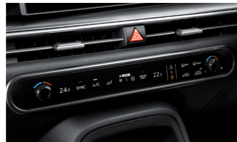
左右独立温度コントロールフルオートエアコン [アフターブロー機能、マイクロエアフィルター、 オートデフォグガー、PMセンサー、空気清浄モード、 後席エアークリア付]
