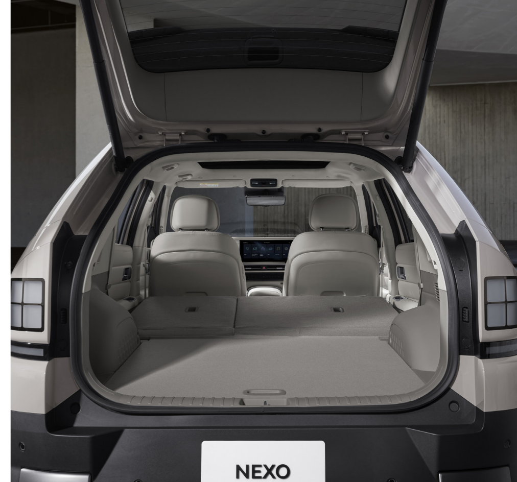
荷室容量：510L / 最大 1,630L [後席フォールディング時] (VDA 方式)
