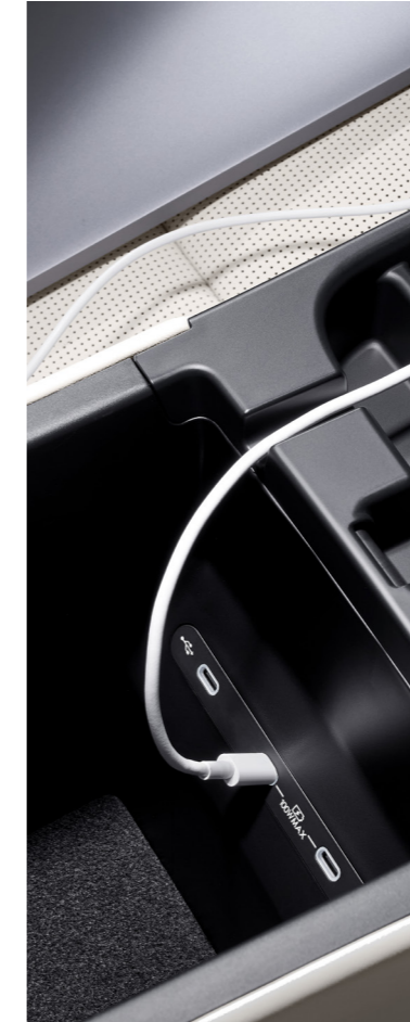
USBポート(Type C) [前席充電・通信*1×1個(27W)、 前席充電×2個/後席充電×2個(計100W)]
