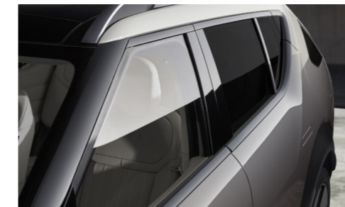
遮音機能付合わせガラス [ウインドシールドガラス、フロント/リヤドアガラス]
