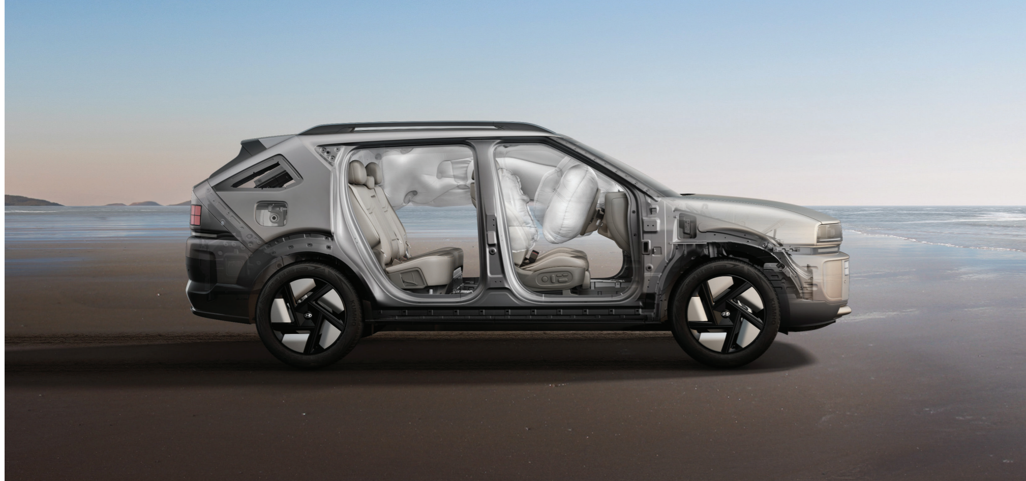
強化プラットフォーム&7エアバッグシステム [SRSエアバッグ(運転席・助手席)+SRSサイドエアバッグ(運転席・助手席)+SRSカーテンエアバッグ(前席・後席/車両転倒センサー付)+SRSフロントセンターエアバッグ]
