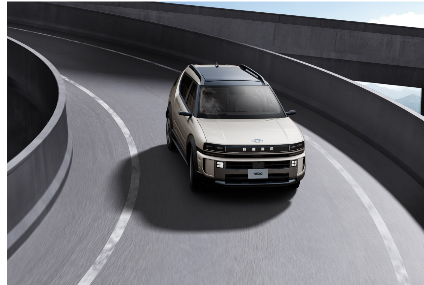
e-ハンドリング 駆動用モーターのトルクを制御し、前後輪の荷重配分を最適化し、ハンドリングをアシストする機能です。 コーナー進入時には、モーターに制動トルクを発生させ、荷重が前輪側へ移動することでフロントタイヤの接地性を高め、優れたステアリングレスポンスを実現します。 一方、コーナー退出時には、瞬間的にモーターの駆動トルクを高め、前輪に集中していた荷重を後輪へ配分し安定性を向上させます。
