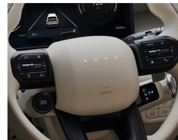
電子制御シフトレバー (SBW) インタラクティブピクセルライト [ステアリングパッド部 LED]
