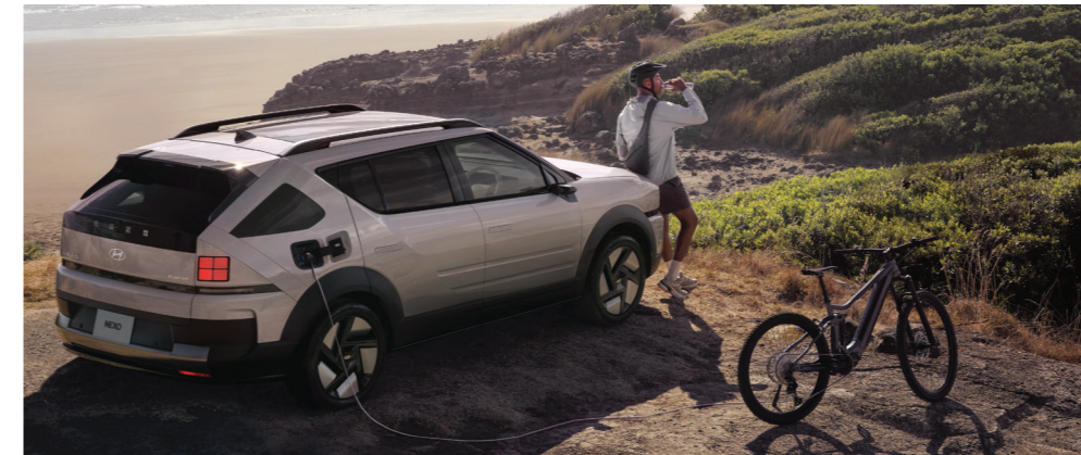
室外V2L (Vehicle to Load) [アダプターレスタイプ、100 V/最大出力 1,500W] V2Lアダプター不要で、車外で家電などへの電力供給が可能です。
