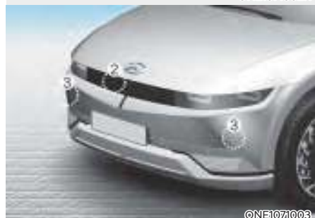
[1]: Kamera depan, [2]: Radadr depan [3] : Radar sudut depan
