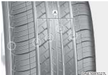
[A] : Indikator keausan tapak ban
