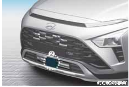
[1]: Ön görüş kamerası, [2]: Ön radar
