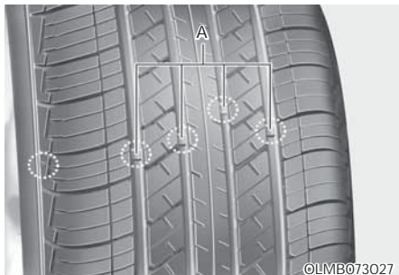
[A] : Sirt aşınması göstergesi
