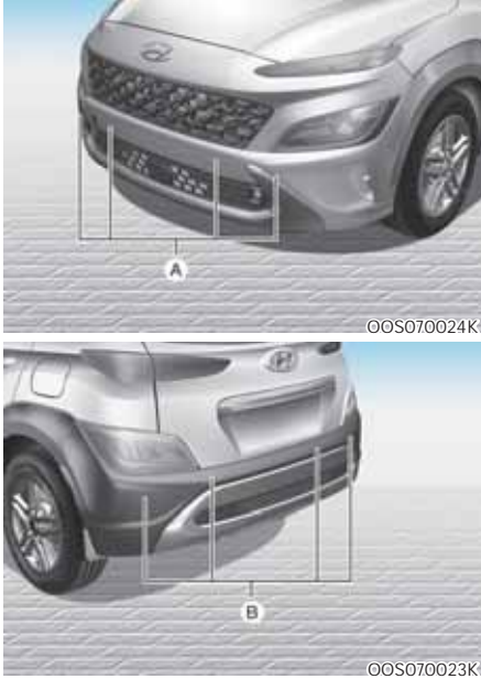
[A] : Ön ultrasonik park sensörleri, [B]: Arka ultrasonik park sensörleri
